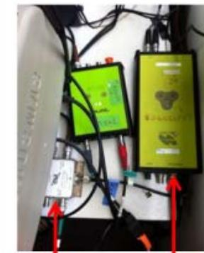
อุปกรณ์แยกสัญญาณ เครื่องรับ GPS (Splitter)
